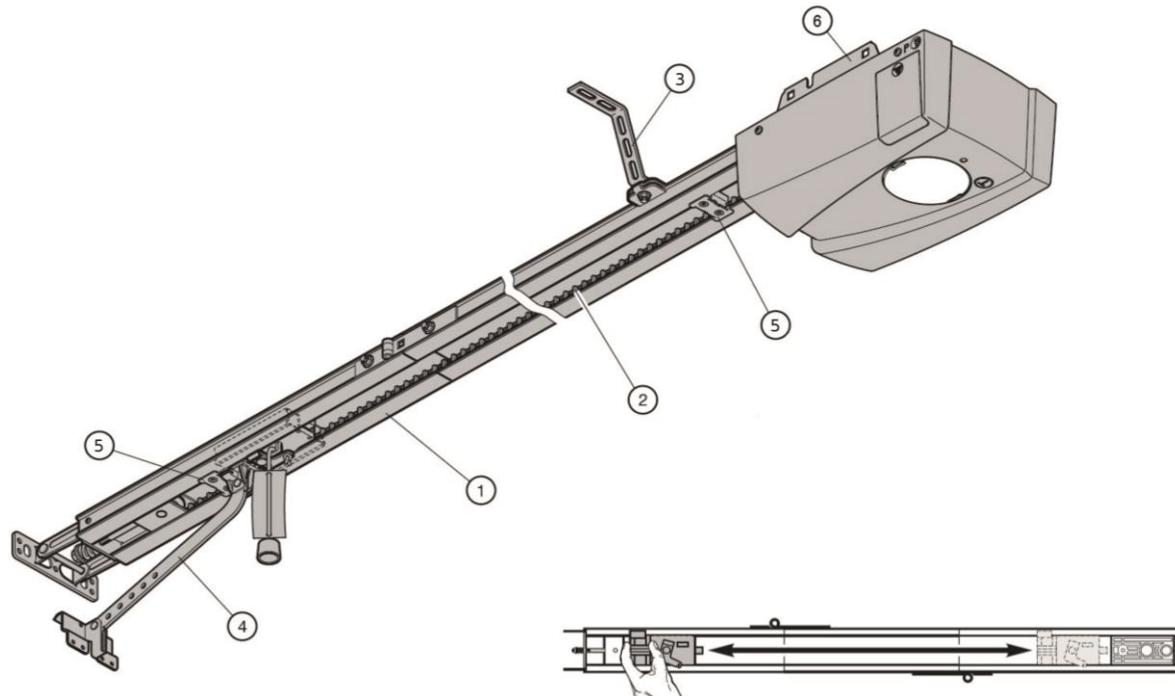
1. Montera ihop den vikbara motorskenan. Kontrollera att släden löper fint över skarvorna
