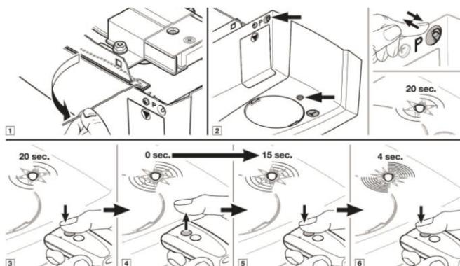
7. Vrid antennen på motorn, rakt ut åt sidan. Tryck en gång på P-knappen och kontrollera att kontrolllampen på motorn blinkar. Tryck in en av knapparna på fjärrkontrollen och kontrollera att den röda lampan på motorn ändrar blinkfrekvens. Tryck på samma knapp ytterligare en gång så att den röda lampan ökar blinkandet.
