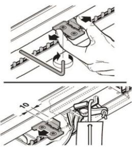
5. Bestäm motorns ändpositioner med hjälp av porten. Montera gränslägesblecken så att porten kan röra sig från stängd och till fullt öppet.
